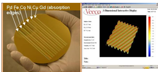
Рисунок 3. Монохроматор-спектрометр, на основе суперполированной толстой подложки кристалла кремния, работающий на полном внешнем отражении. И исследование качества структуры в интерферометре.
