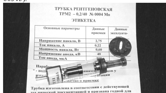
Рисунок 2. Фотография малогабаритной рентгеновской трубки ТРМ2-02/40 (Mo) прострельного типа мощностью 8 Вт.
